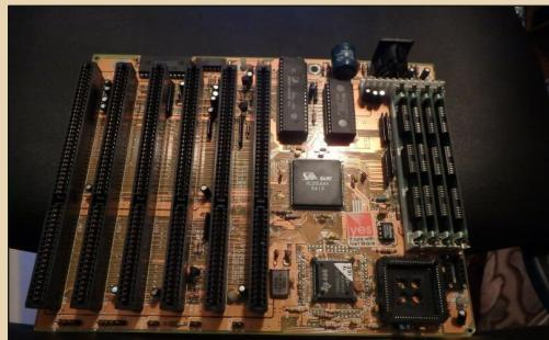
Рис. 6. Материнская плата с 486SLC – как раз на неё было решено водрузить и видеокарту, и, возможно, данный жёсткий диск
