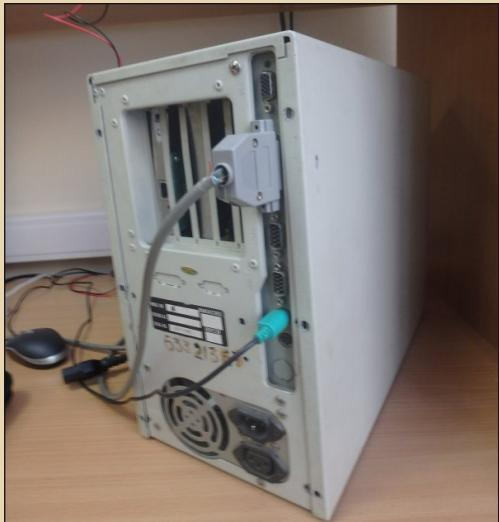
Рис. 3. Вид сзади – собственно, всё то же самое, что мы привыкли видеть на брендовых системных блоках LPX, но повернуто на 90 градусов
