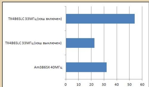
Рис. 7. Сравнительный тест 386SX 40 МГц и 486SLC 33 МГц – с выключенным и включенным кэшем
