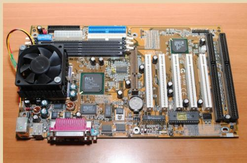
Она поддерживает широкие диапазоны питающих процессор напряжений, множителей и частот системной шины. На борту 2 ISA,
